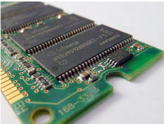
**Abb. 17** Arbeitsspeicher in Form eines ICs auf einem SDRAM-Modul (Foto: Laserlicht - Wikimedia Commons)
